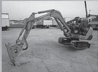
油圧等で駆動する打撃式破碎機（ブレーカユニット）をアタッチメントとして装備した機械。鉄筋コンクリート造のビル等の解体に使用される。
