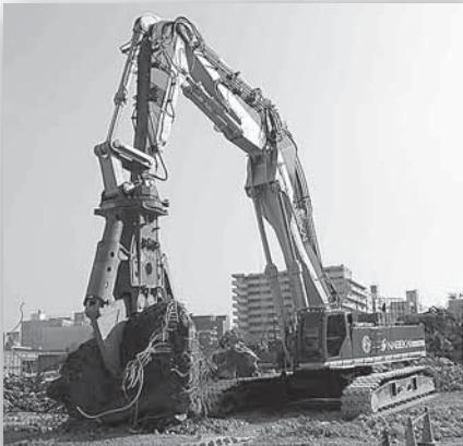
コンクリート構造物を押し碎くため、油圧で駆動するはさみ状のアタッチメントを装着した機械。鉄筋を切断する機能を付加したものを含む。
